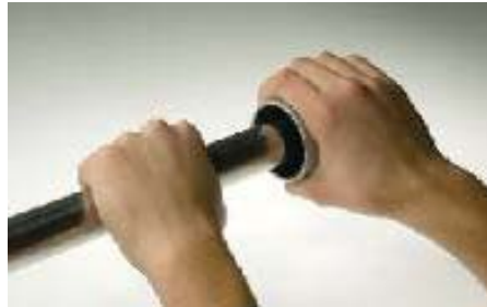
2- Снятия фаски с торцов трубы
